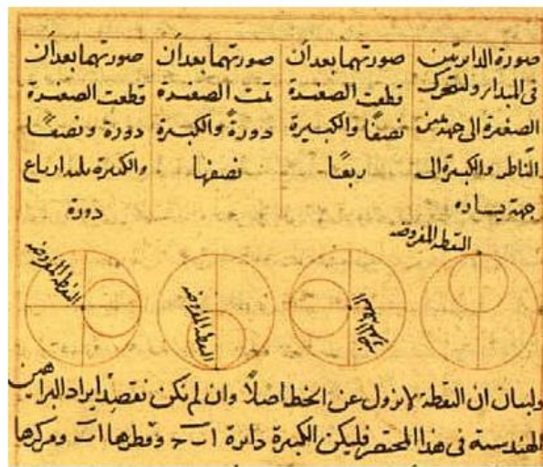
شكل (11): آلية رياضية أبدعها الطوسي في نمودجه لحركة الكواكب يمكن بواسطتها توليد حركة مستقيمة من حركتين دائريتين، وقد اقتبس كوبرنيكوس هذه الآلية عنها دون الإشارة إلى مصدرها، ولم يكن لها من مصدر آخر!
